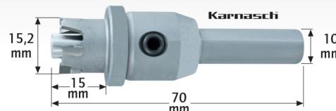
■ À utiliser en combinaison avec une perceuse/perceuse puissante à accus. Cette scie à guichet permet de pénétrer dans la plaque frontale située devant le cœur de ce cylindre de fermeture grande sécurité puis d'en extraire le cœur.
